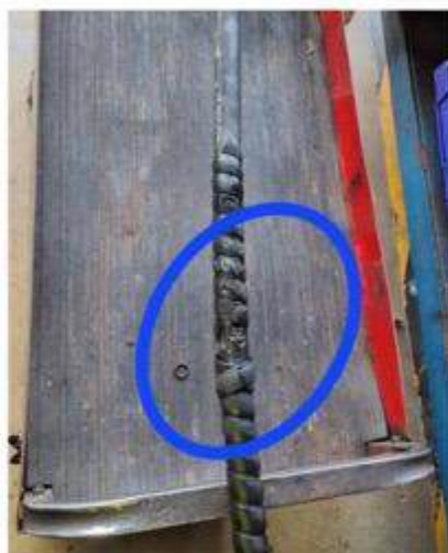
Imagen 2. Evidencia del equipo que presenta daño.
