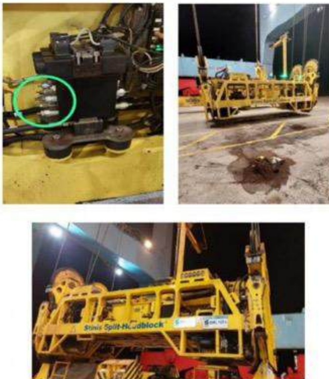
Imagen 1. Evidencia del derrame.
