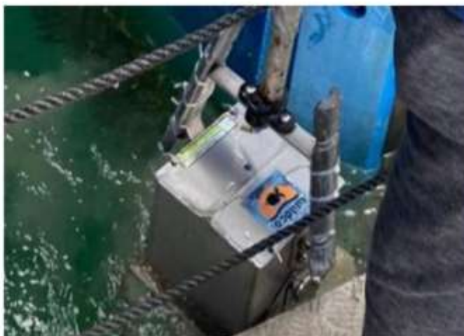
Figura 3. Draga saca bocado utilizada para obtener el sedimento del fondo.
