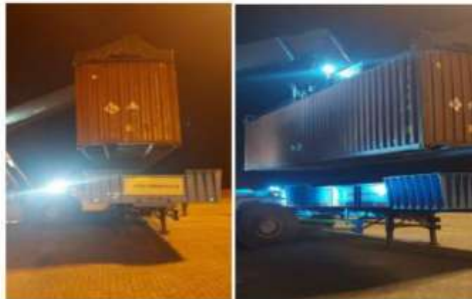
Imagen 4. Contenedor con derrame ubicándose en chasis especial para la contención de derrames.
